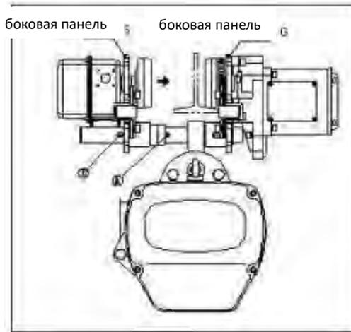
**Рисунок 5. Схема присоединения подвесной тележки к балке**
